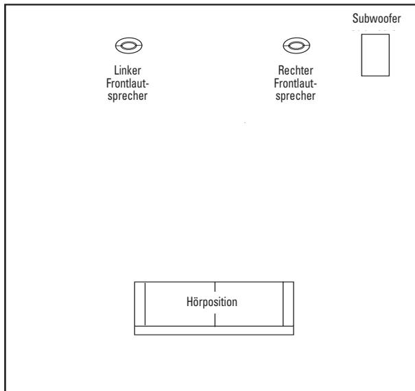
Abbildung 1: Diese Wohnraumaufsicht zeigt die optimale Aufstellung der Lautsprecher. Die Aufgabenverteilung lautet wie folgt: Die Satelliten-Lautsprecher werden für die Wiedergabe der beiden Front-Kanäle eingesetzt. Der aktive Subwoofer ist bei der Musikwiedergabe für Bassfrequenzen und beim Abspielen von Filmsoundtracks für die Effekte zuständig.
