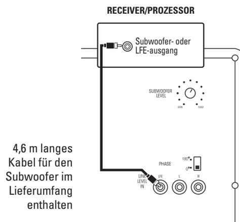
Ist Ihr Receiver/Prozessor nicht mit einem Dolby® Digital- oder DTS®-Prozessor ausgestattet, besitzt aber trotzdem einen separaten Subwoofer-Ausgang, nehmen Sie bitte folgende Kabelverbindungen vor:
