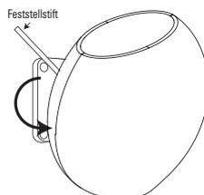
Abbildung 2. Halterung für die Wandmontage
