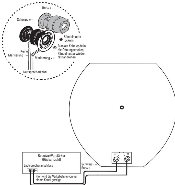
Abbildung 3: Der hier vorliegende Verkabelungsplan zeigt die nötigen Kabelverbindungen für ein Heimkino-System.
