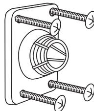
**Schritt 4.** Schrauben Sie die Überwurfmutter (C) ab.
