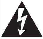
Das gleichseitige Dreieck mit Blitz- und Pfeilsymbol dient zur Warnung des Benutzers vor nicht isolierter "gefährlicher Spannung" innerhalb des Gehäuses, die stark genug sein kann, um Personen durch Stromschlag zu gefährden.
